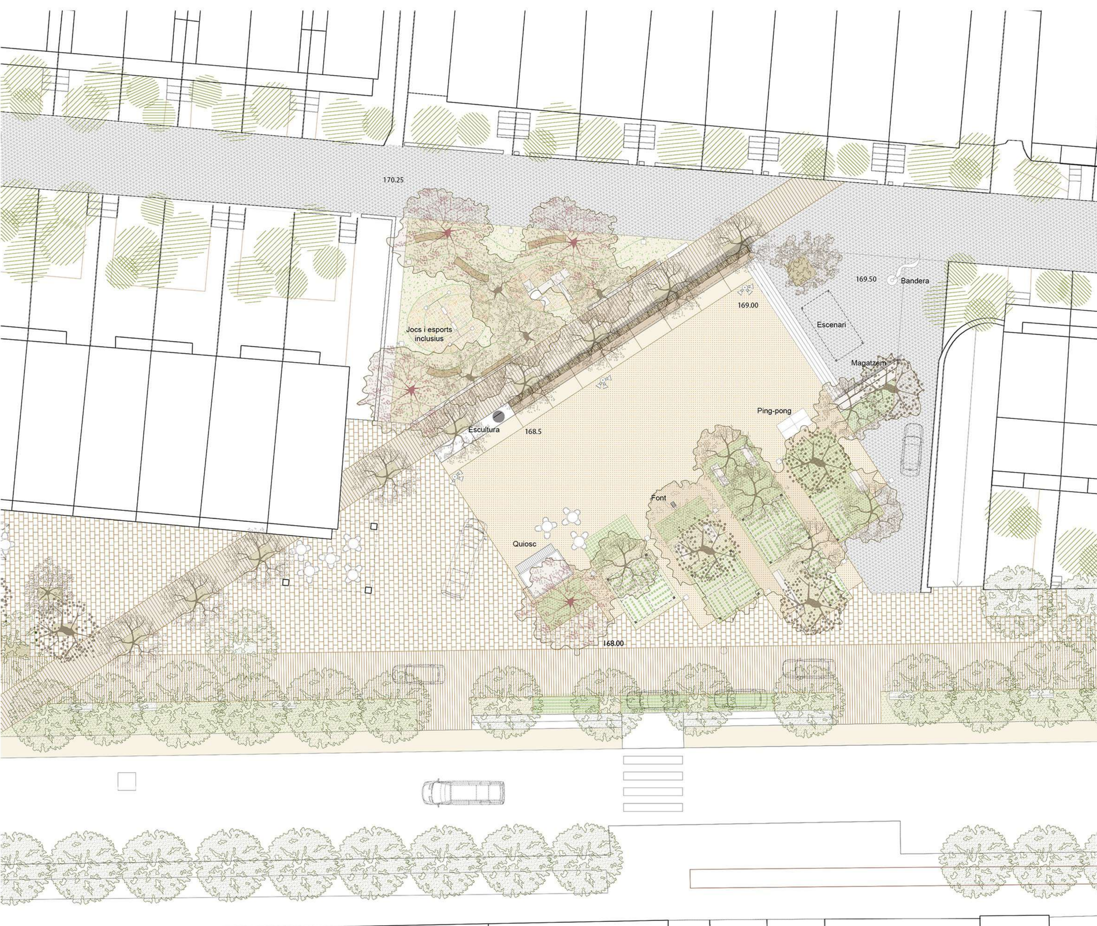
Llambordí de formigó Llambordí de formigó amb junta verda Sauló estabilitzat Mur de gabions amb pedra reciclada Estabilització de terra existent Fusta per conformar bancs
