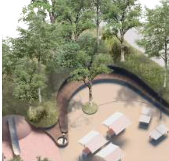
El banc, un espai fresc i protegit del sol a l'estiu, actua també com a mur de contenció de les terres del talús.
