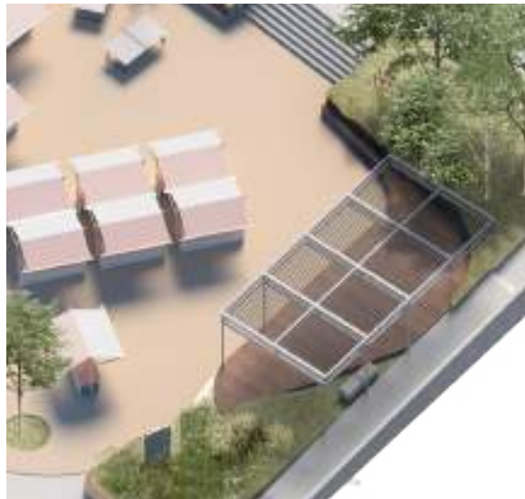
Una pèrgola amb coberta fotovoltaica que alhora protegeix l'escenari.
